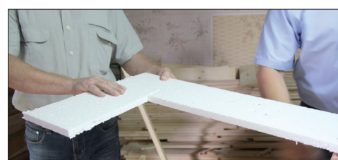
Пенопласт плотностью 15 кг/м 3 (20 мм) используется для утепления улья
