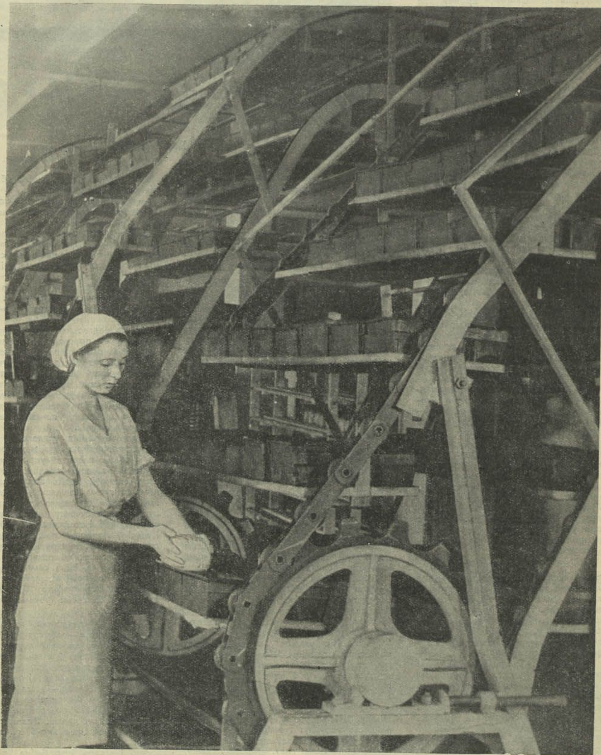
На Мінскім хлебаводзе № 3 калектыў рацыяналізатараў пад кіраўніцтвам галоўнага інжынера І. Ліхача сканструяваў механічны канвеер расстойкі цеста, што дало павышэнне прадукцыйнасці працы на 150 прац. Гадавая эканомія канвеера — 75 тыс. рублёў. На здымку: фармаўшчыца Ляўко Мар'я за абслугоўваннем канвеера расстойкі цеста.
