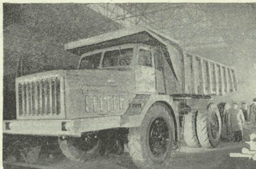
На Мінскім аўтамабільным заводзе група канструктараў пад кіраўніцтвам Е. І. Калмыкова стварыла магутны аўтамабіль-самазвал «МАЗ-530» грузапад'ёмнасцю ў 40 тон. Фото В. Лупейкі.
