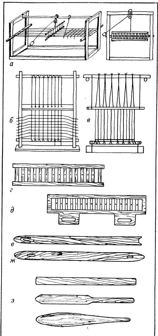
**Кросны гарызонтальныя (а), кросны вертыкальныя (б, в), бёрды (г, д), ігліца (е), іголка (ж), трапалы (з)**
