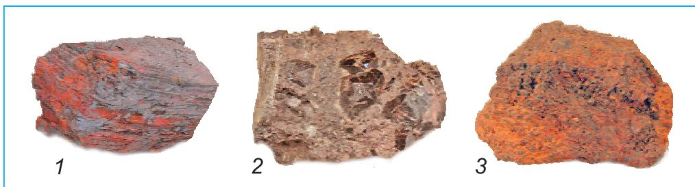
Рис. 49. Руды: 1 — железная; 2 — алюминиевая (боксит); 3 — медная
