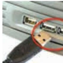
Рисунок 105 — Разъём USB для устройства флэш-памяти
