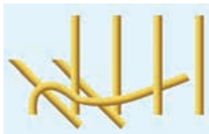
Мал. 26. Пачатак пляцення простаі загібкі за дзве стойкі
