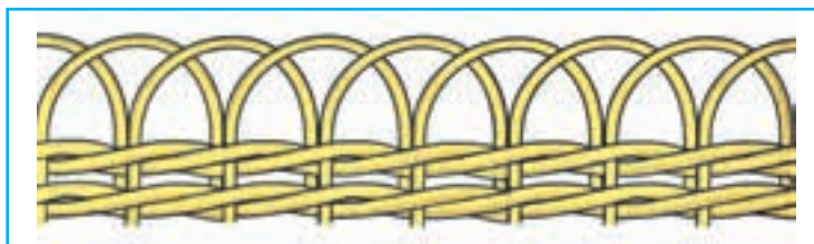
Рис. 10. Ажурная загибка в один прут
