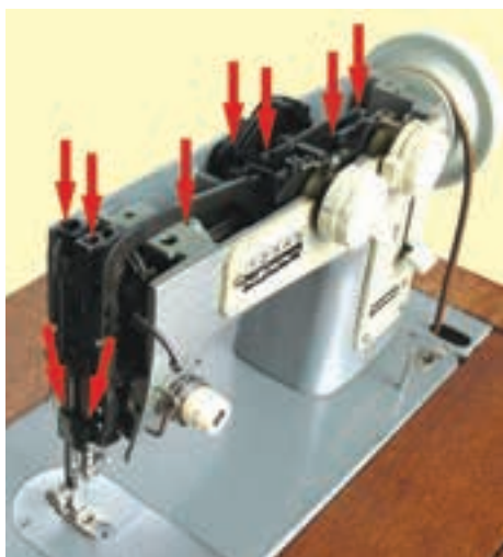
Мал. 8. Схема змазкі швейнай машыны
