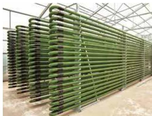
Рис. 36. Установка для выращивания хлореллы
