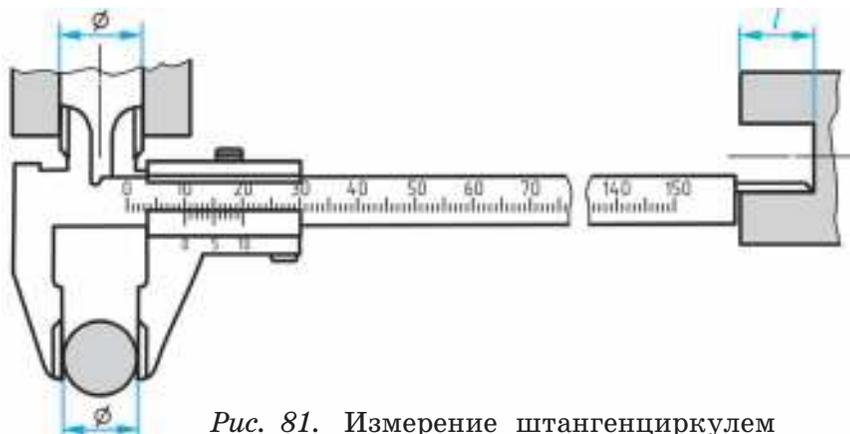
Рис. 81. Измерение штангенциркулем
