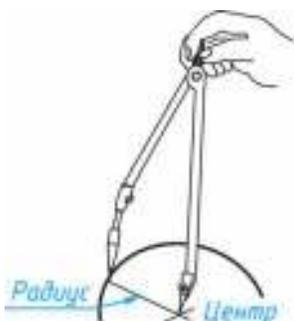
Рис. 4. Проведение окружности циркулем
