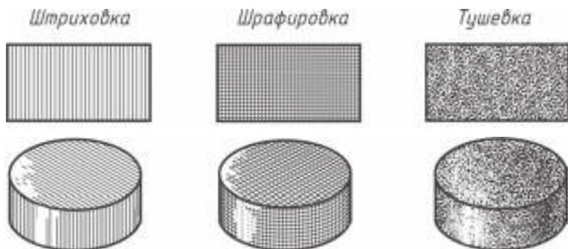
Рис. 65. Способы передачи объема предмета на техническом рисунке
