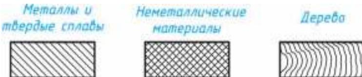
Рис. 123. Графические обозначения материалов в сечении
