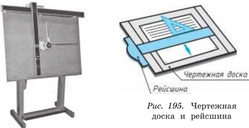
Рис. 195. Чертежная доска и рейсшина
