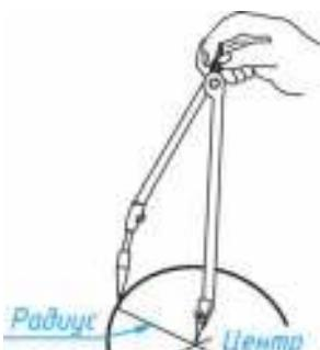
*Рис. 4. Проведение окружности циркулем*
