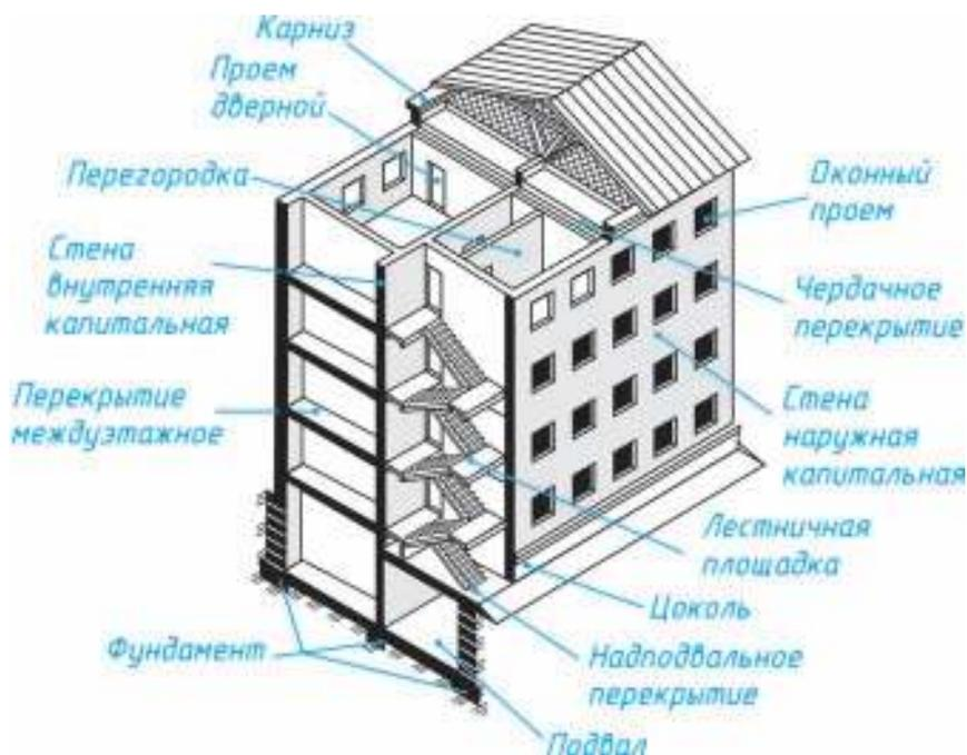
Рис. 186. Части и элементы здания
