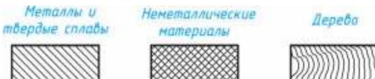
*Рис. 123. Графические обозначения материалов в сечении*
