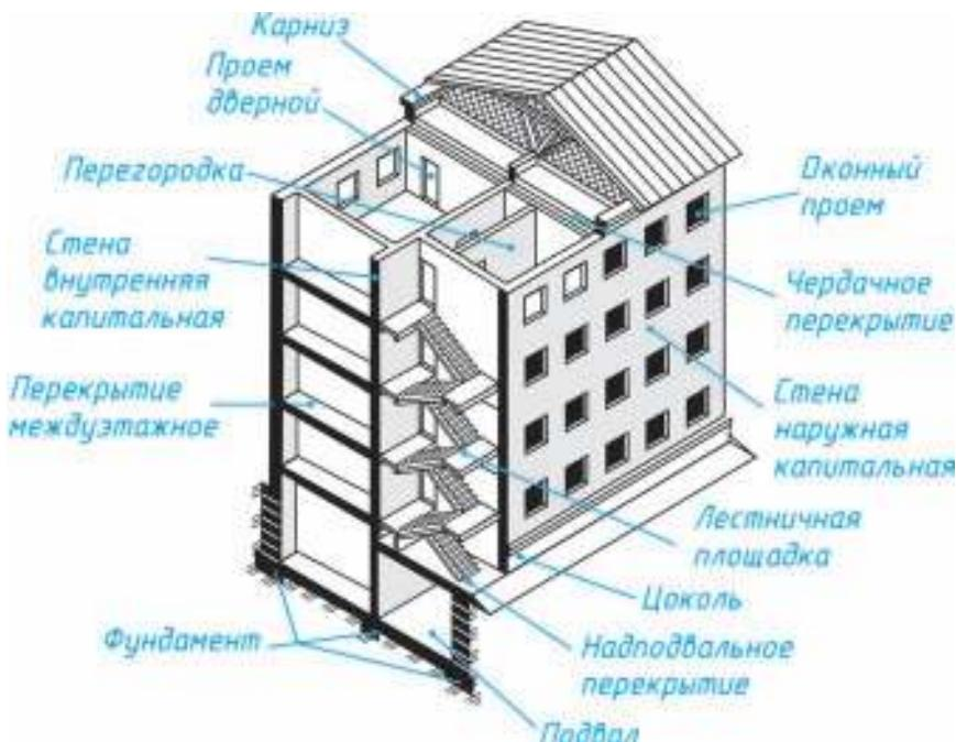
Рис. 186. Части и элементы здания
