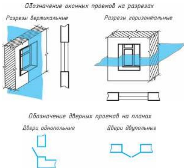
*Рис. 187.* Условное изображение оконных и дверных проемов зданий
