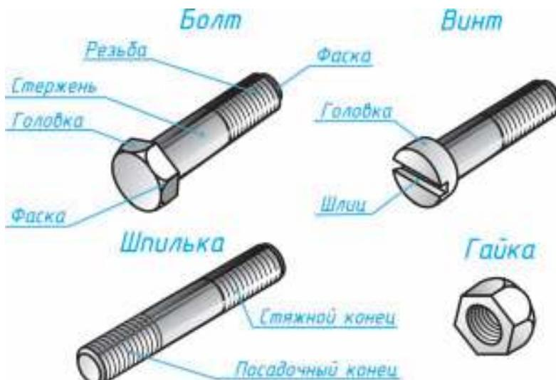
Рис. 161. Крепежные детали
