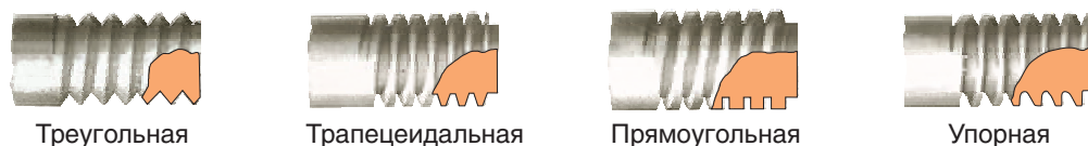
Рис. 86. Виды резьбы по профилю
