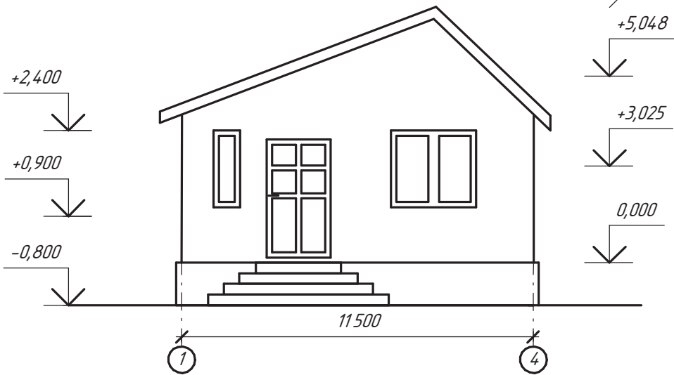
Рис. 105. Числовые отметки высоты
