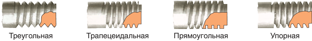
Рис. 86. Виды резьбы по профилю
