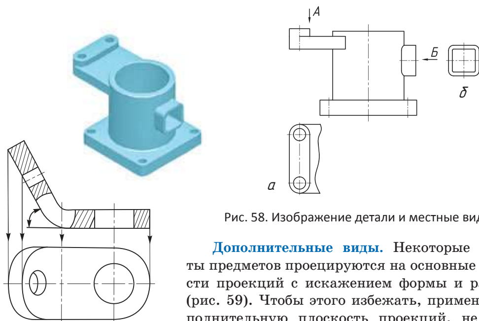
Рис. 59. Проецирование предмета с искажением
