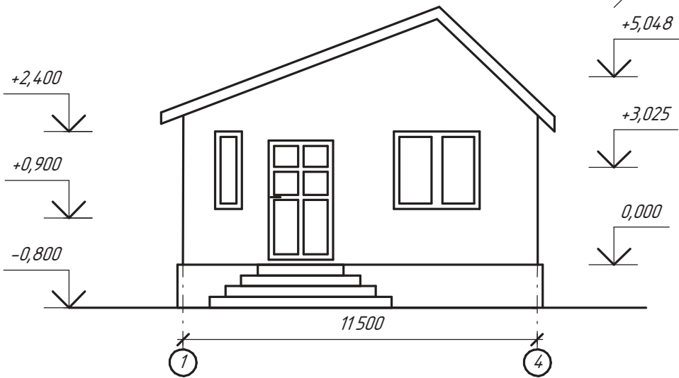
Рис. 105. Числовые отметки высоты
