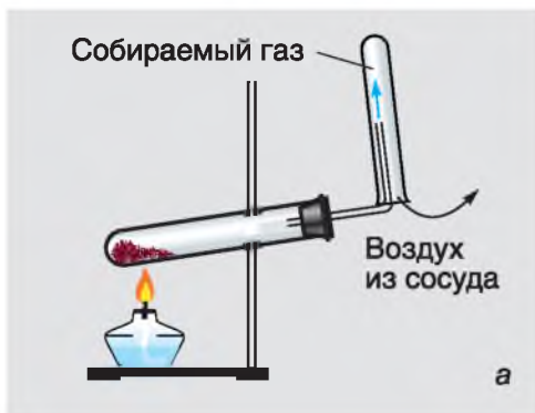
Рис. 55. Схема установки для собирания газов методом вытеснения воздуха
