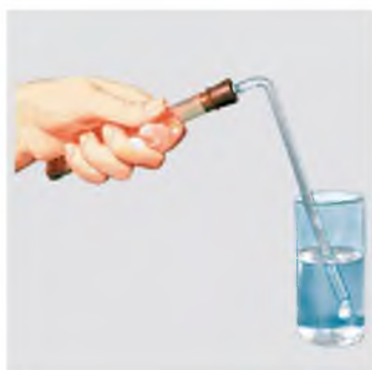
Рис. 57. Проверка прибора на герметичность
