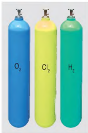
Рис. 56. Стальные баллоны для хранения газов
