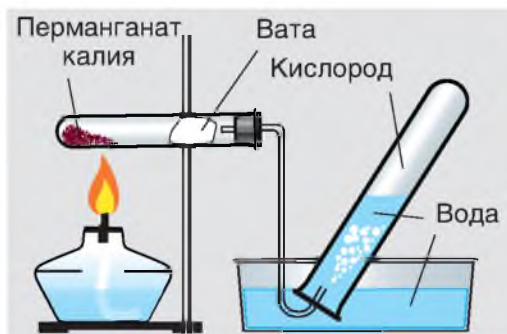
Рис. 63. Получение кислорода из \text{KMnO}_4
