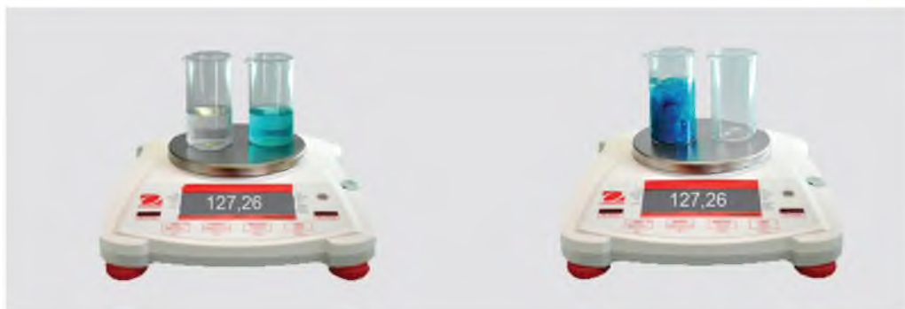
Рис. 49. Доказательство закона сохранения массы веществ в химических реакциях
