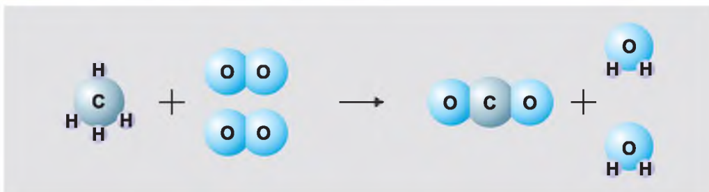
Рис. 53. Схема реакции метана с кислородом
