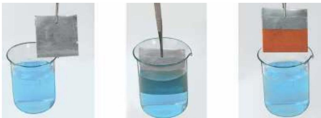
Рис. 84. Реакция железа с хлоридом меди(II) в растворе
