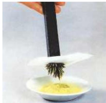
Рис. 91. Разделение магнитом смеси железа и серы
