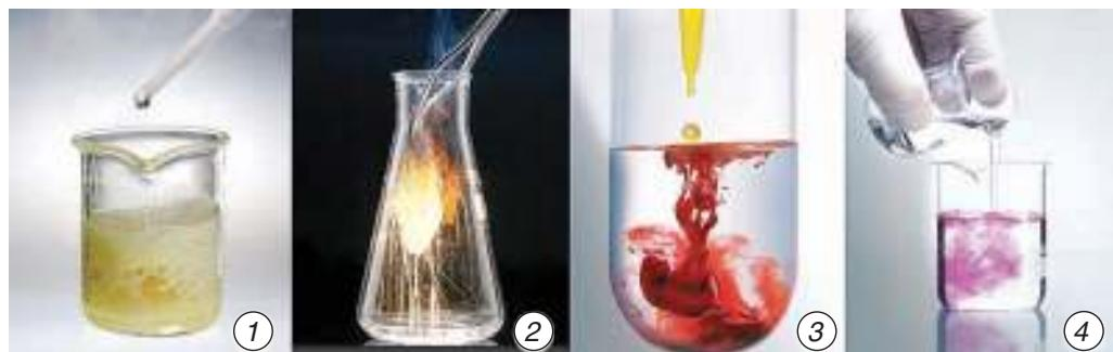
Рис. 13. Признаки химических реакций: 1 — выделение газа; 2 — излучение света и выделение теплоты; 3 — образование осадка; 4 — изменение цвета
