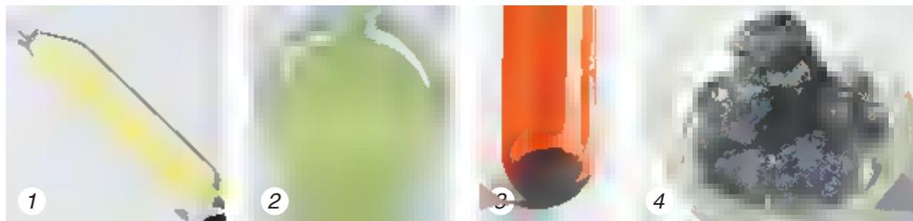
Рис. 40. Окраска простых веществ-галогенов: 1 — фтора, 2 — хлора, 3 — брома, 4 — иода
