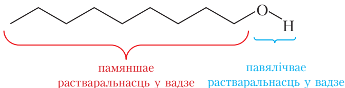
Мал. 23.8. Уплыў вуглевадароднага радыкала і гідраксільнай групы на здольнасць спіртоў растварацца ў вадзе
