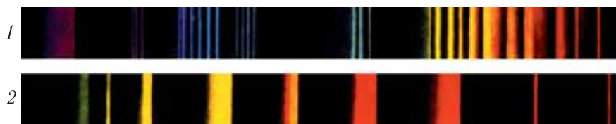
Рис. 137. Полосатые спектры испускания: 1 — угольной дуги; 2 — молекул йода
