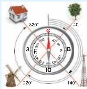
Поручим выполнение алгоритма исполнителю Шестиклассник в предположении, что он понимает и может правильно выполнить команды алгоритма. Результат выполнения алгоритма: азимут на дерево равен  $40^\circ$ ; азимут на вышку сотовой связи равен  $140^\circ$ ; азимут на мельницу равен  $220^\circ$ ; азимут на дом равен  $320^\circ$ .
