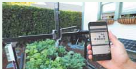
Рабатызаваная сістэма, прызначаная для вырошчвання агародніны. Кіраванне дадзенай сістэмай ажыццяўляецца праз Wi-Fi. Ёсць магчымасць аддаленага кантролю праз Інтэрнэт.
