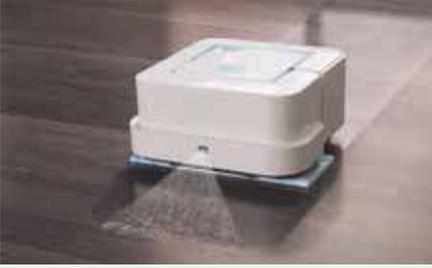
Робот-пылесос с помощью системы камер и сенсоров может ориентироваться в комнате и строить маршрут уборки.
