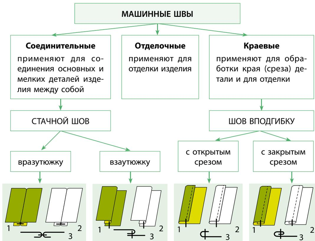
Рис. 76. Виды машинных швов: 1 — образец;
