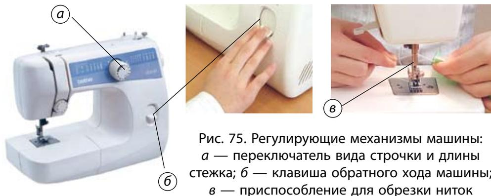
Рис. 75. Регулирующие механизмы машины:
