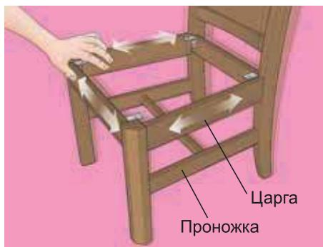
Рис. 140. Проверка стула на прочность соединений
