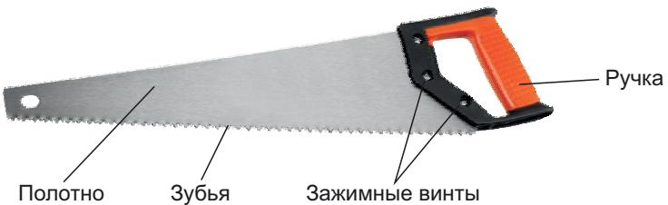
Рис. 41. Строение столярной ножовки
