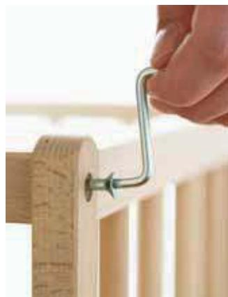
Рис. 138. Установка евровинта
