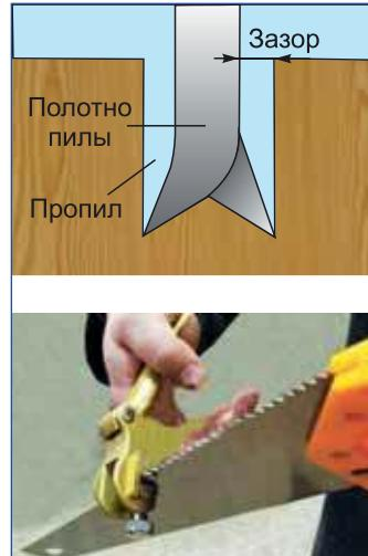
Рис. 46. Развод зубьев пилы
