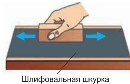
Рис. 84. Шлифование мелких деталей
