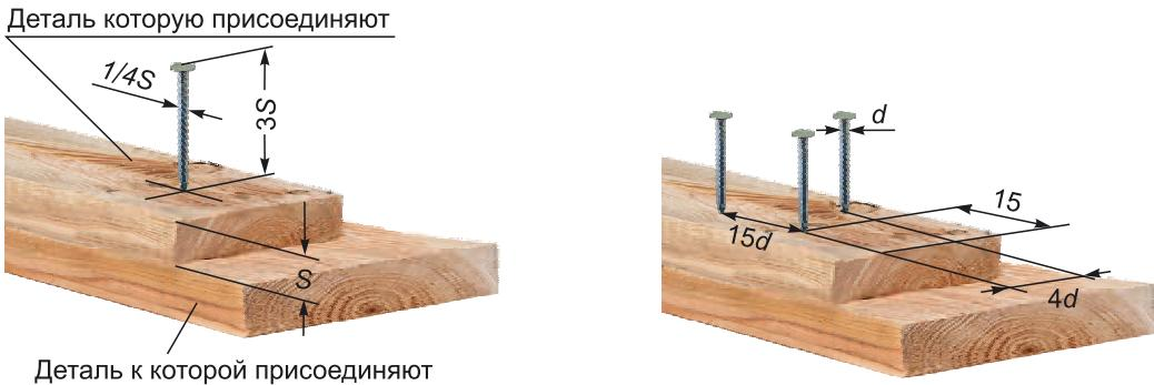
Рис. 72. Разметка мест соединения деталей гвоздями
