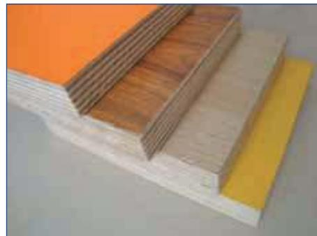
Рис. 24. Ламинированная фанера
