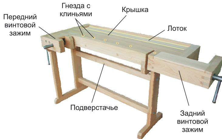
Рис. 5. Устройство столярного верстака
