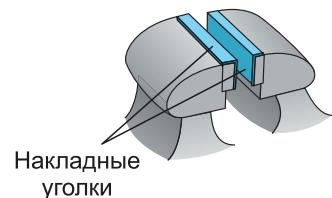
Рис. 90. Оснащение съемных (накладных) губок на-кладными уголками
