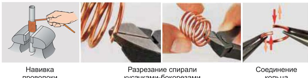
Рис. 133. Изготовление спирали из проволоки
