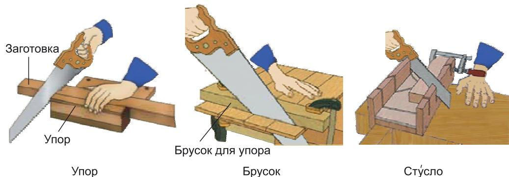
Рис. 44. Приспособления для пиления
