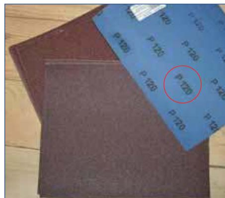
Рис. 82. Обозначения зернистости на шлифовальной шкурке
