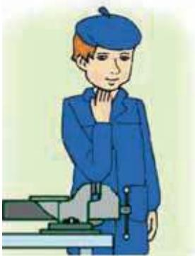
Рис. 91. Подбор тисков в соответствии с ростом учащегося
