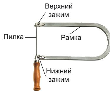
Рис. 55. Устройство ручного лобзика
