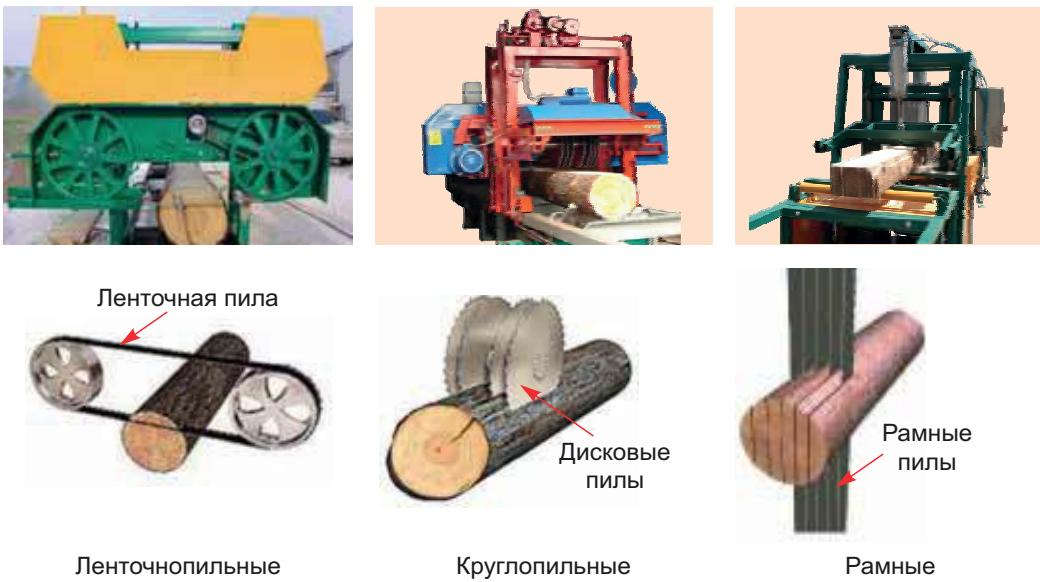
Рис. 19. Виды бревнопильных станков
