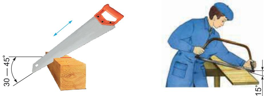
Рис. 45. Угол наклона пилы при пилении толстых пиломатериалов (слева) и тонких пиломатериалов и фанеры (справа)
