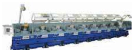
Рис. 103. Оборудование для волочения проволоки
