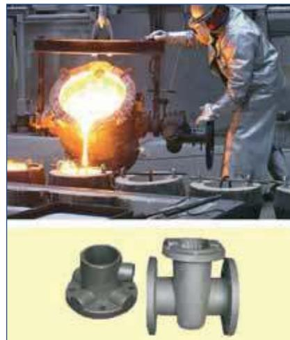
Рис. 96. Тигель для литья (вверху) и отлитые изделия из металла (внизу)
