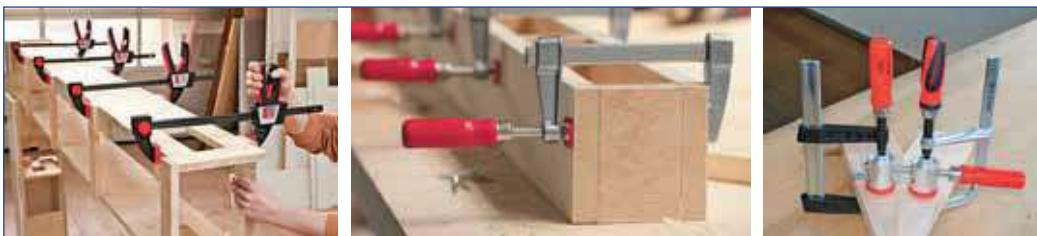
Рис. 70. Фиксация склеенных деталей струбцинами
