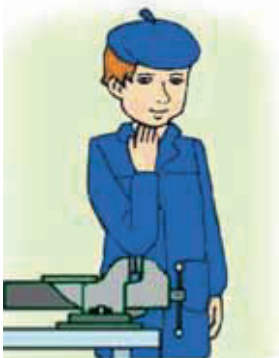
Рис. 91. Подбор тисков в соответствии с ростом учащегося
