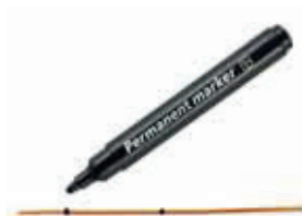
Рис. 118. Разметка проволоки маркером
