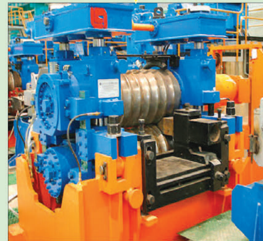
Получение проволоки на прокатном стане
