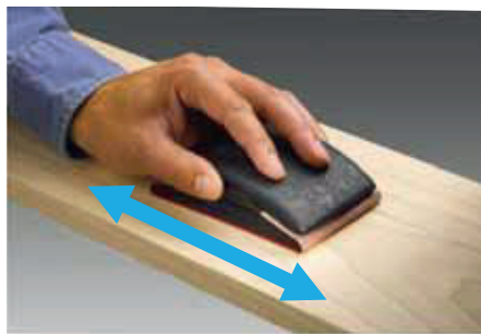
Рис. 83. Шлифование при помощи бруска (слева) и шлифовальной колодки (справа)
