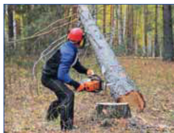
Рис. 12. Валка леса ручными бензопилами
