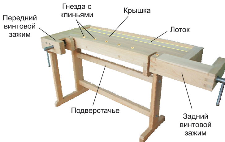
Рис. 5. Устройство столярного верстака
