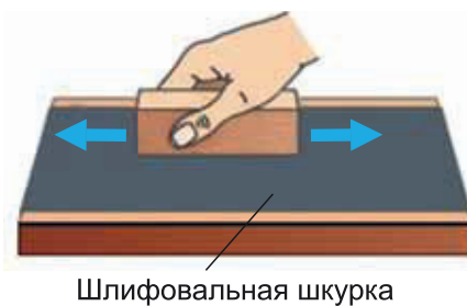
Рис. 84. Шлифование мелких деталей
