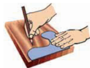
Рис. 35. Шаблон (вверху) и разметка по шаблону
