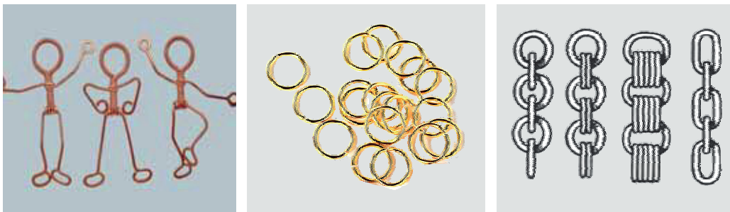
Рис. 135. Сборка изделий из проволоки: переплетением (слева) и продеванием (в центре и справа)
