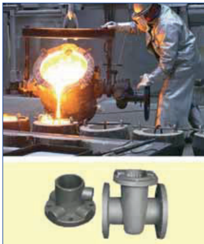
Рис. 96. Тигель для литья (вверху) и отлитые изделия из металла (внизу)
