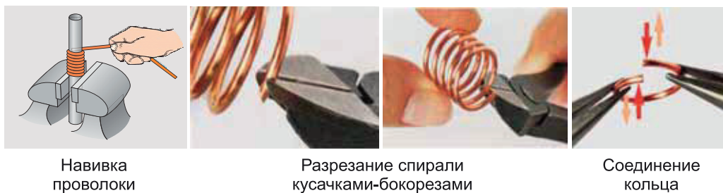
Рис. 133. Изготовление спирали из проволоки
