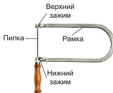
Рис. 55. Устройство ручного лобзика
