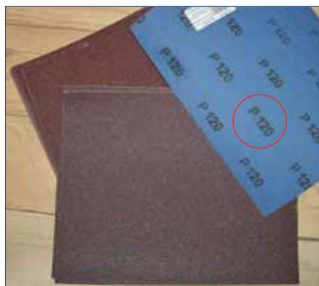
Рис. 82. Обозначения зернистости на шлифовальной шкурке
