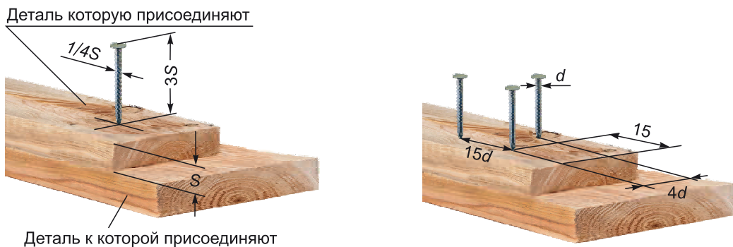
Рис. 72. Разметка мест соединения деталей гвоздями
