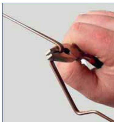
Рис. 125. Приемы сгибания проволоки под углом
