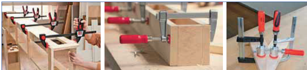
Рис. 70. Фиксация склеенных деталей струбцинами
