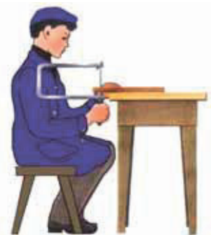
Рис. 66. Рабочая поза при выпиливании лобзиком
