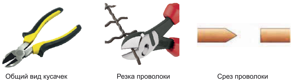
Рис. 121. Резка проволоки кусачками-бокорезами
