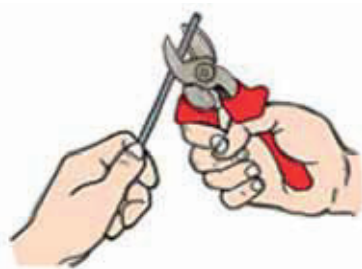
Рис. 120. Хватка инструмента при резке проволоки кусачками
