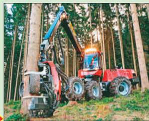
Валка леса при помощи харвестера
