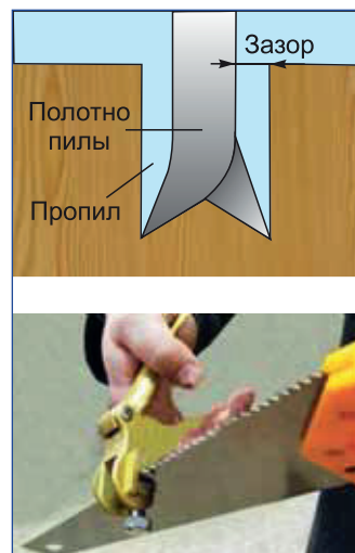
Рис. 46. Развод зубьев пилы
