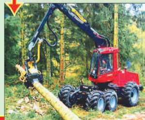
Очистка стволов от веток и сучьев, раскряжёвка на сортименты
