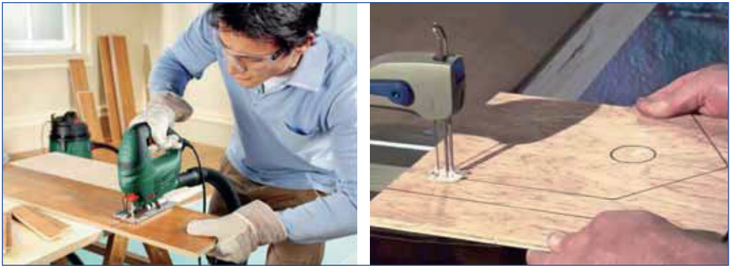
Рис. 65. Работа электрическим лобзиком: ручным (слева) и стационарным (справа)
