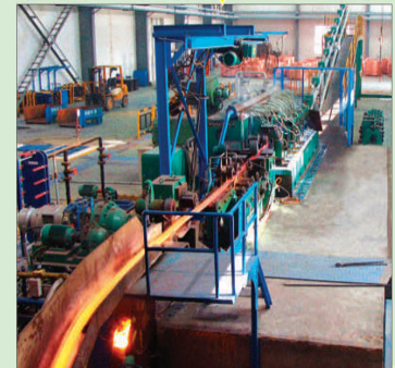
Получение проволоки на волочильном стане
