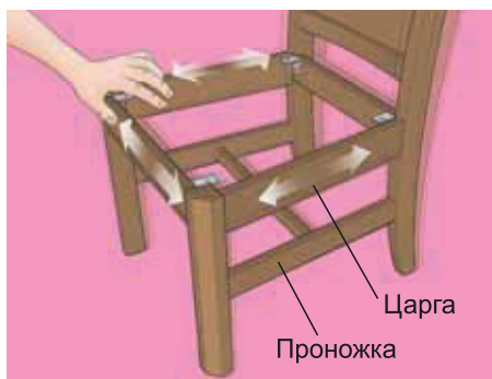
Рис. 140. Проверка стула на прочность соединений
