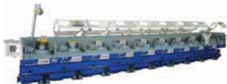
Рис. 103. Оборудование для волочения проволоки
