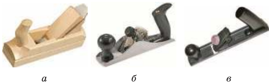
Рис. 14. Инструменты для строгания древесины: а — деревянный рубанок; б — металлический рубанок; в — шерхебель
