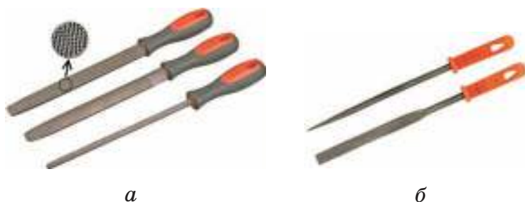
Рис. 25. Инструменты для зачистки древесины: а — рашпили; б — надфили
