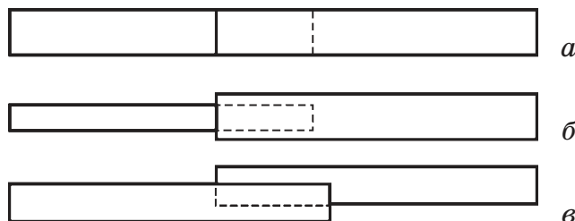
Рис. 84. Схемы наращивания соломки: а — «внахлёт»; б — «в отверстие»; в — «в расцеп»
