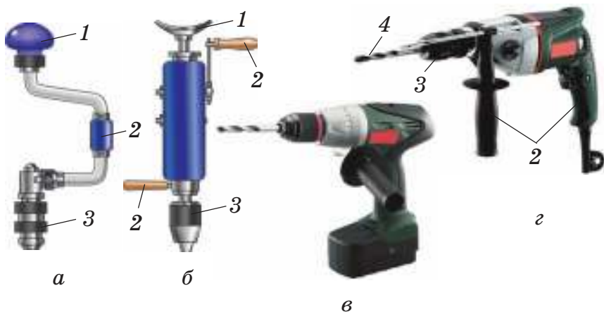
Рис. 21. Инструменты для сверления отверстий: а — коловорот; б — дрель механическая; в , г — дрели электрические: 1 — упор, 2 — ручки, 3 — патроны для закрепления сверла, 4 — сверло
