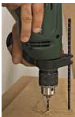
Рис. 22. Работа ручным инструментом: а — коловоротом: 1 — заготовка, 2 — струбцина, 3 — подкладная доска, 4 — верстак; б — дрелью механической; в — дрелью электрической
