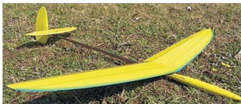
Рис. 67. Мадэлі планёраў з пенапласту і драўніны
