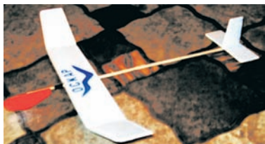
Рис. 67. Мадэлі планёраў з пенапласту і драўніны
