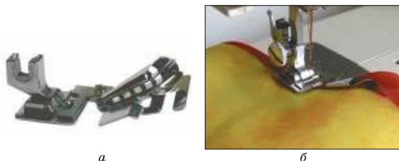
Рис. 42. Окантовыватель (а); окантовывание края ткани косой бейкой при помощи окантовывателя (б)
