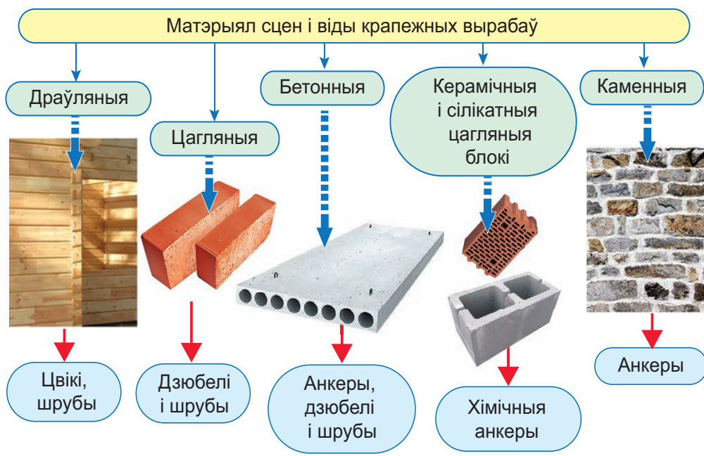
Мал. 133. Віды крапежных вырабаў у залежнасці ад матэрыялу сцяны
