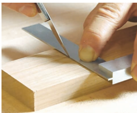
Мал. 40. Разметка пры дапамозе разметачнага нажа
