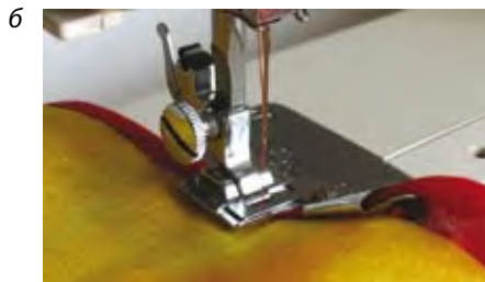
Мал. 93. Акантавальнік (а), акантоўванне краю тканіны косай бейкай пры дапамозе акантавальніка (б)
