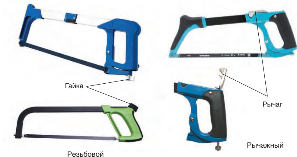
Рис. 62. Механизмы крепления ножовочного полотна
