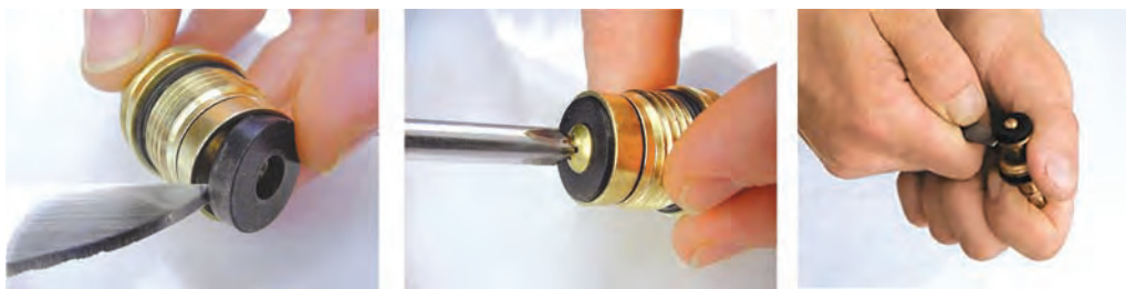
Рис. 109. Замена прокладки в кран-буксе
