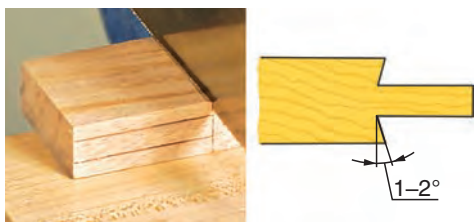
Рис. 16. Запиливание заплечиков
