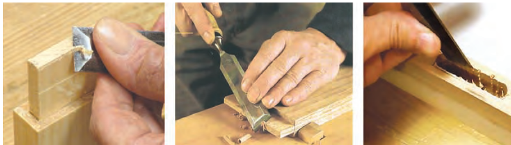
Рис. 22. Зачистка стамеской шипа (слева и в центре) и гнезда (справа)
