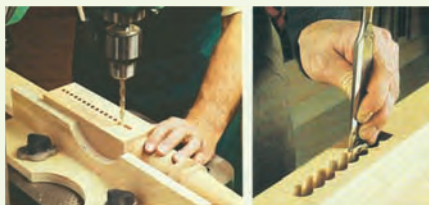
Сверление и зачищение гнезд
