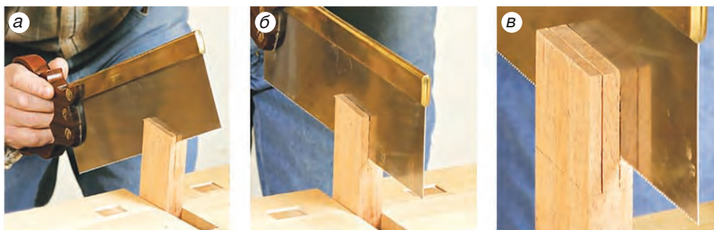
Рис. 15. Запиливание шипов и проушин
