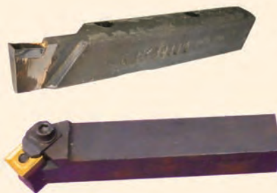
Рис. 88. Токарные резцы: цельный (вверху), со сменной пластиной (внизу)
