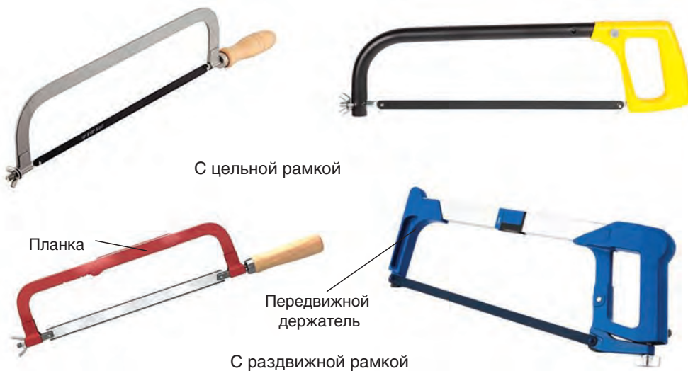
Рис. 59. Конструкции слесарной ножовки
