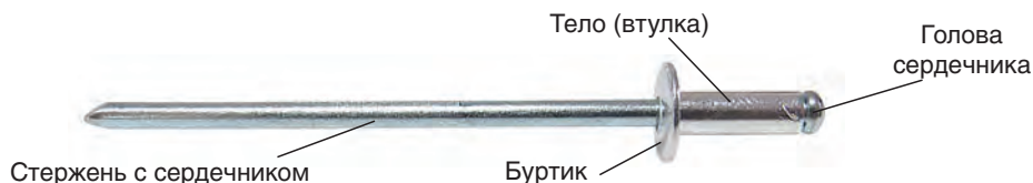
Рис. 81. Строение вытяжной заклепки
