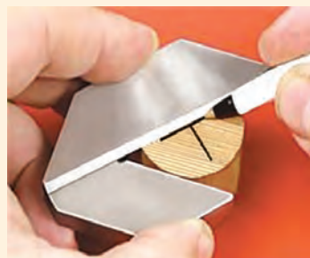
Рис. 40. Определение центра торца заготовки при помощи центроискателя
